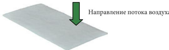
Д. Замена фильтрующего элемента среднего фильтра: удерживайте за выступы с обеих концов фильтрующего элемента среднего фильтра и осторожно извлеките его из углубления в высокоеффективном фильтре. Замените новым элементом, выступы которого должны смотреть вверх, и вдавите его в углубление в высокоеффективном фильтре.
