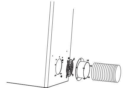
Указания по монтажу трубы-глушителя
