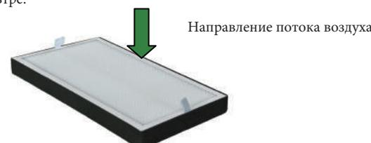
Е. Замена высокоеффективного фильтрующего элемента: после снятия первичного фильтра и среднего фильтра извлеките главный фильтр, удерживая его с двух сторон и осторожно потянув его вверх. Замените новым главным фильтром, вставив его в устройство, а затем поочередно вставьте средний фильтр и первичный фильтр.
