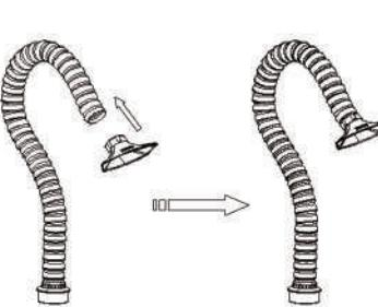
Указания по монтажу крышки из силикагеля
