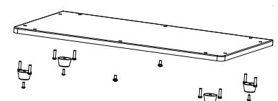
Указания по монтажу подкладок для ножек аппарата
